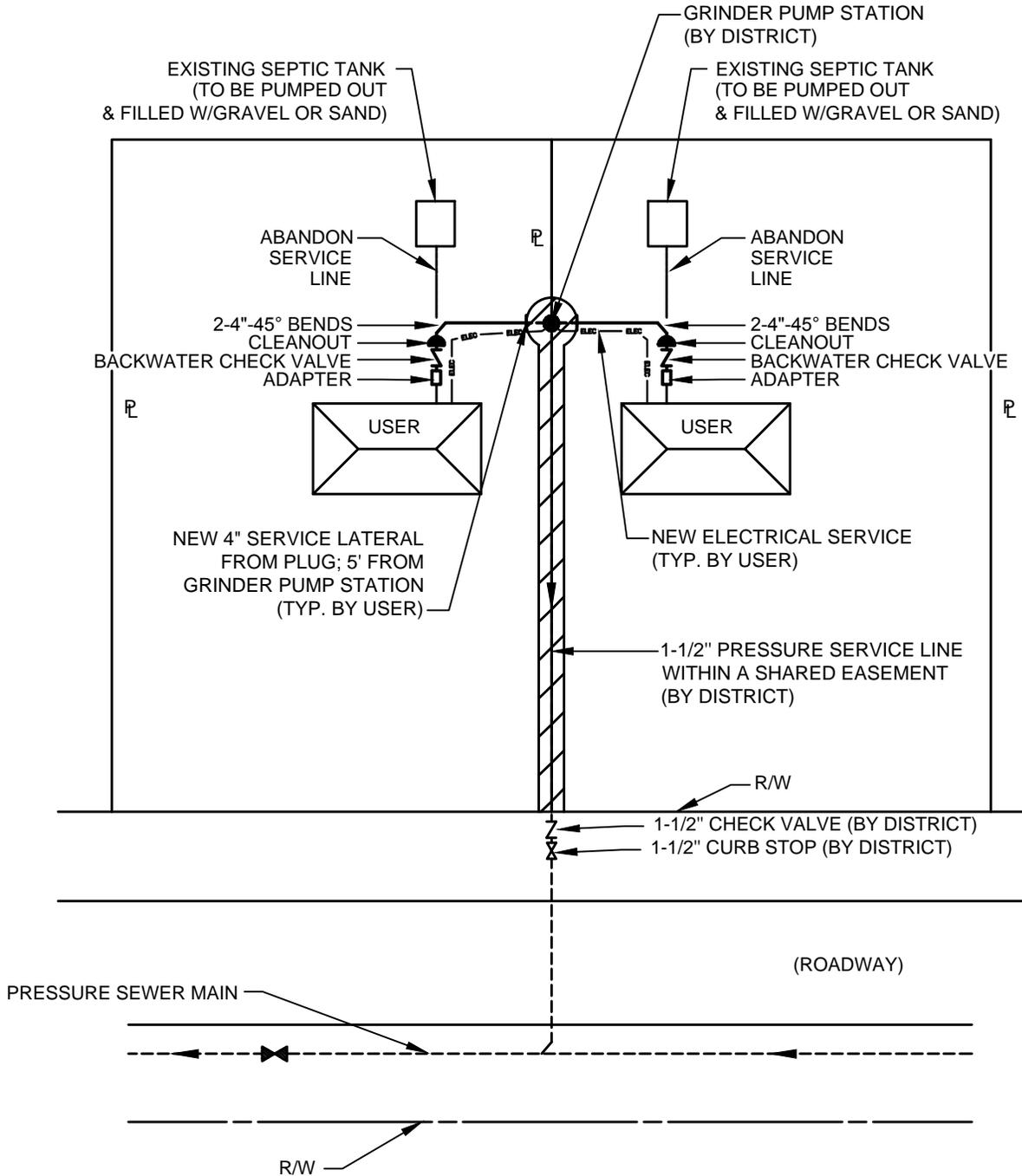
**TYPICAL SHARED GRINDER PUMP STATION LAYOUT & TAP PLAN**
