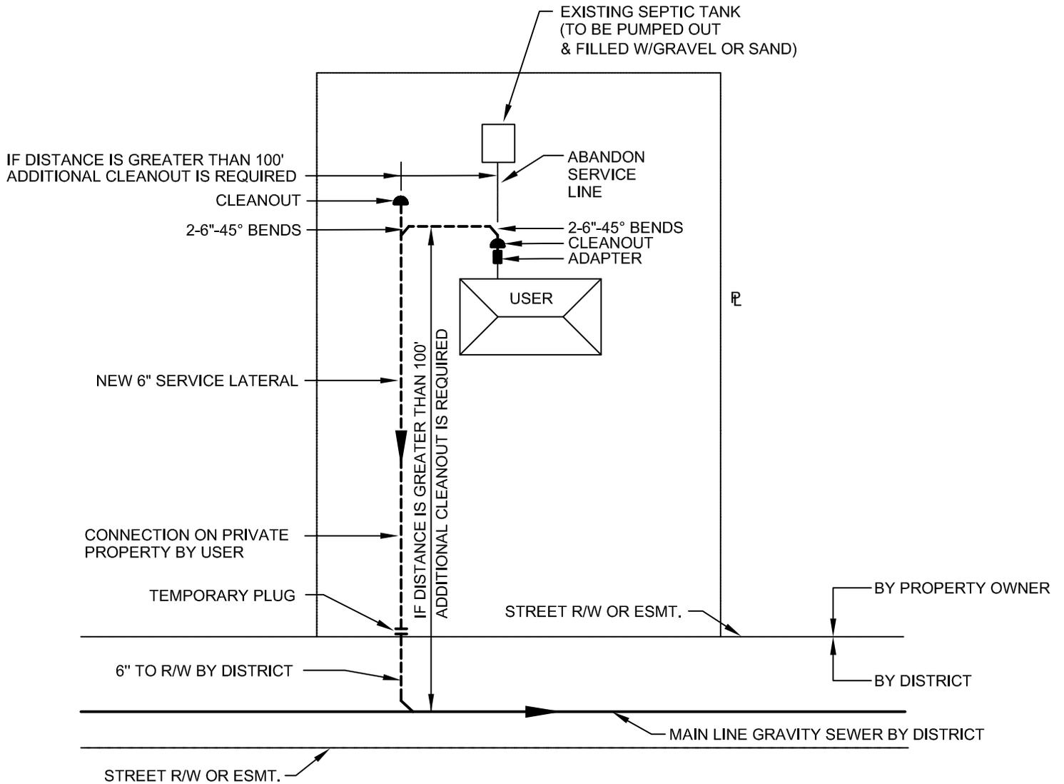
TYPICAL GRAVITY SEWER TAP PLAN
