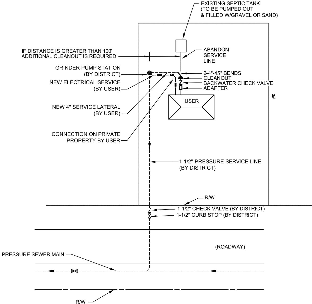
**TYPICAL GRINDER PUMP STATION LAYOUT & TAP PLAN**
